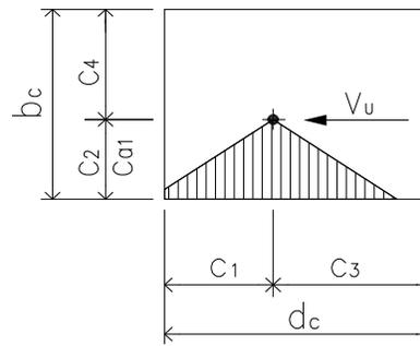
Conc Shear Breakout Parallel To Edge
