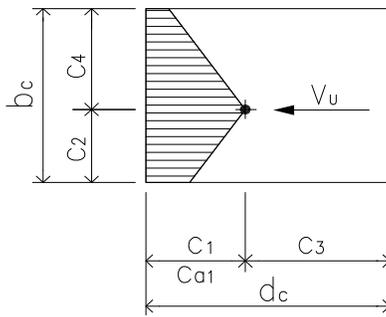
Conc Shear Breakout Perpendicular To Edge
