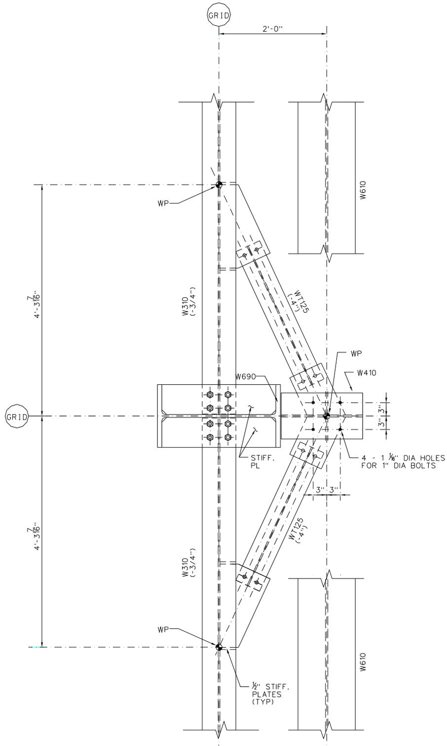
CRANE RUNWAY BEAM CONNECTION - PLAN
